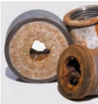
Gefahr durch Lochfrass: EWS-Systeme bieten aktiven Schutz für Rohrleitungen.
